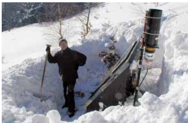
Obr. 3: ZTE-21 zařízení pro sledování chování sesuvu v období zimy 2001 až 2002
